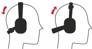
La **banda textil** tiene la función de mantener las orejeras correctamente posicionadas, evitando que se deslicen hacia abajo cuando el protector es utilizado con **casco** (diadema rebatida hacia la nuca).
